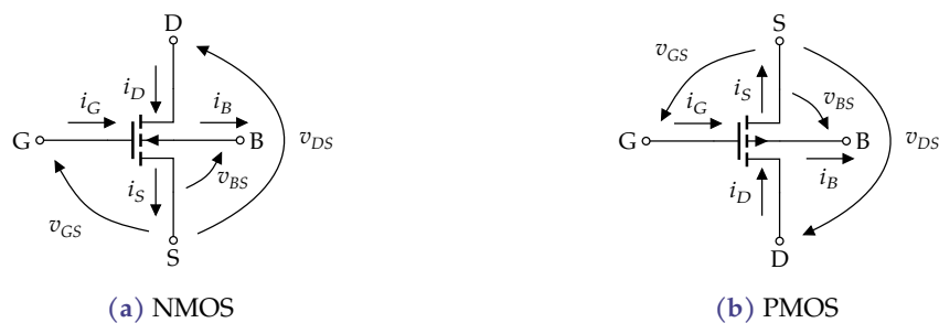
Figuur 7.4: Stroom- en spanningsconventies voor de MOSFET
