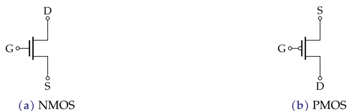
Figuur 7.2: De MOSFET symbolen gebruikt door digitale ontwerpers: het inversiesymbool aan de gate van de PMOS geeft aan dat de gate' actief laag is; digitale ontwerpers tekenen geen bulk -contact omdat ze doorgaans niet vrij kunnen bepalen hoe het aangesloten wordt; ze maken ook zelden het onderscheid tussen depletion en enhancement MOSFETs (soms wordt het kanaal bij een depletion MOSFET dikker getekend)
